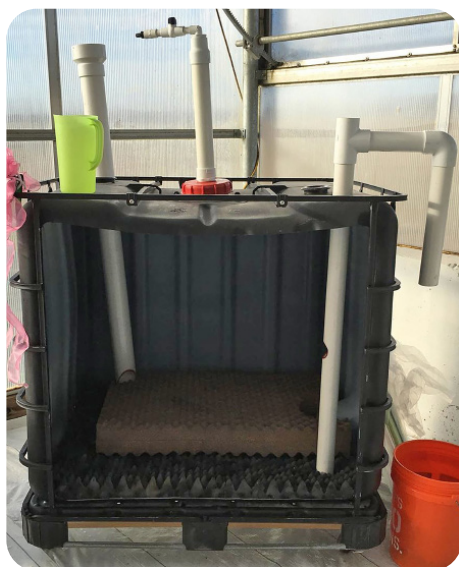
Esimerkki IBC-säiliöön tehdystä mädättämöstä
